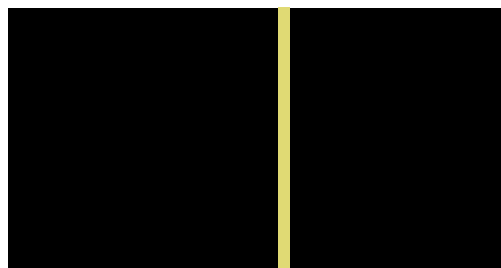
Рис. 26. Спектральное распределение энергии излучения натриевых ламп низкого давления
