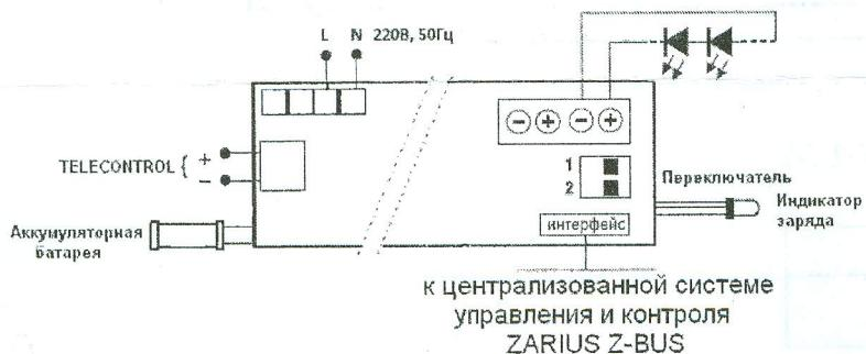
Схема подключения для аварийного светильника постоянного действия.
