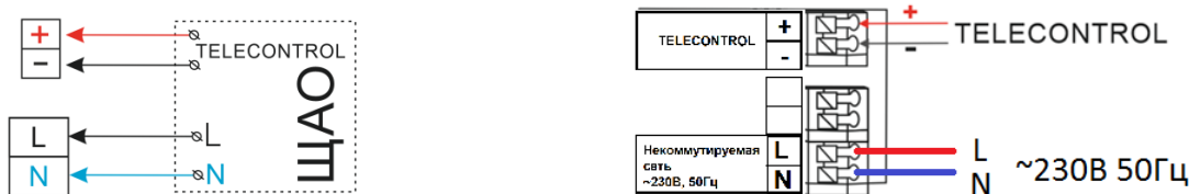
Рис. №1 Схемы подключения к групповой цепи питания и к групповой цепи управления.
