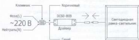
Рис. 2. Схема подключения светодиодной рамки-светильника к сети 220 В
