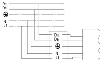
3. Схема подключения светильника CORFUN к питающей сети.
