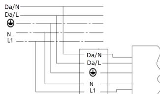
4. Схема подключения светильника к питающей сети с регулированием по системе 1-10V или 0-10V
