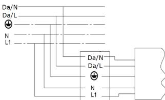
4. Схема підключення світильника до мережі живлення з регульованням по системі 1-10V або 0-10V
