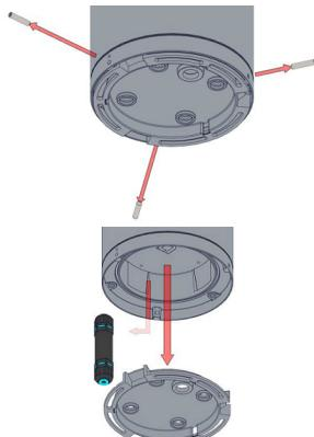
4. Закрепить монтажное основание на твердую поверхность с помощью анкерных болтов, согласно рисунка. Рекомендуется использовать позицию «Закладная анкерная D108» артикул 4126001120 (в комплекте не входит). При использовании комплекта, шпильки M8 бетонируются во всю длину оставляя необходимый припуск для крепления светильника.
