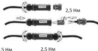
6. Вложить разъем внутрь светильника, установить светильник на монтажное основание и зафиксировать его с помощью 3 винтов. Включить питание. Винты крепления светильника, должны смазываться смазкой типа Литол-24 - раз в год.
