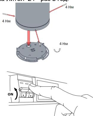
7. При установке светильника на монтажное основание необходимо обеспечить равномерную (без перекоса частей светильника) затяжку установочных винтов по окружности.
