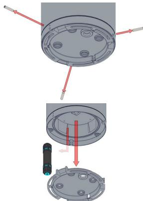
4. Закріпити монтажну основу на тверду поверхню за допомогою анкерних болтів, відповідно до малюнка. Рекомендується використовувати позицію «Закладна анкерна D108» артикул 4126001120 (до комплекту не входить). При використанні комплекту, шпильки M8 бетонуються у всю довжину залишаючи необхідний припуск для кріплення світильника.
