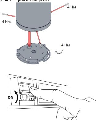
7. При установці світильника на монтажну основу необхідно забезпечити рівномірну (без перекосу частин світильника) затяжку настановних гвинтів по колу.
