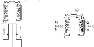
5. Зафіксувати адаптер шляхом повороту фіксатора, розташованого на ньому.
