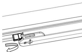
6. При демонтажі світильника, звільнити адаптер шляхом повороту фіксатора та витягнути його з шинопровода.
