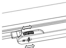
4. Встановити світильник на шинопроводі за допомогою адаптеру. При установці звернути увагу на розташування виступів адаптеру та шинопроводу. Монтаж світильника проводити тільки в знеструмленому стані шинопроводу.
