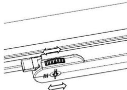
4. Адаптердің көмегімен шинасымда шамшырақты орнату керек. Орнатқан кезде адаптер мен шино сымның дөңес жерлерінің орналасуына назар аудару керек. Шамшырақ монтажын шинасым тоқсыздандын жағдайда жүргізу керек.
