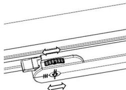
4. Установить светильник на шинопроводе с помощью адаптера. При установке обратить внимание на расположение выступов адаптера и шинопровода. Монтаж светильника проводить только в обесточенном состоянии шинопровода.
