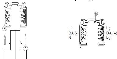
5. Зафиксировать адаптер путем поворота фиксатора, расположенного на нем.
