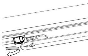
6. Шырақты демонтаждағанда фиксатор бұрылышымен адаптерді босатыңыз және шиносымнан оны шығарыңыз.
