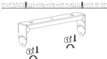
3. Установить светильник в необходимое положение, закрутив винты кронштейна (M5x16).
