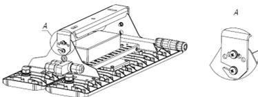
4. Подключение светильника к питающей сети (диаметр подключаемого кабеля 6-10 мм, максимальное сечение провода 2,5 мм<sup>2</sup>).
