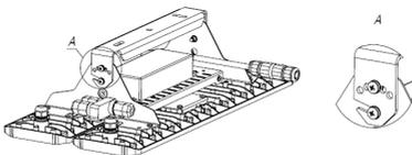
4. Шырақты қуат көзі желісіне қосыңыз (қосылатын кабельдің диаметрі 6-10 мм, сымның максималды қимасы 2,5 мм<sup>2</sup>). Коннекторды бөлшектеңіз. Қуат көзі кабелінің (ҚК) оқшаулағышын тазалау, сыртқы-20 мм, ішкі - 8-10 мм. Қуат көзі кабелін коннектор сомыны арқылы қосыңыз және сымдарды кереғарлықты сақтай отырып клеммдік қалыпқа қосыңыз: L, N, PE. Тығыздағыш серпімді сығылғанға дейін сомынды бұрап, коннекторды жинаңыз. Ұстатқыш бұранданың тартылу сәті 0,5 Н·м.
