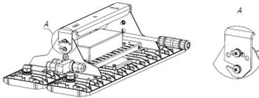
4. Підключення світильника до мережі живлення (діаметр кабелю, що підключається 6-10 мм, максимальний перетин проводу 2,5 мм<sup>2</sup>).
