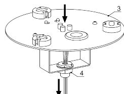
6. Встановити підставу чашки (3) на горизонтальну опорну поверхню за допомогою саморізів (не входять до комплекту постачання). Відкрити кришку коннектору (5), відкрутити два самореза та розкрити кабельні затискачі. Підключити мережевий провід до клемної колодки, зафіксувати його за допомогою кабельного зажиму та саморізу.
