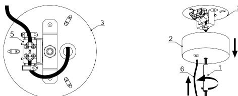
9. Установить потолочную чашку (2) на основание (3) и зафиксировать ее с помощью декоративной стойки (1).
