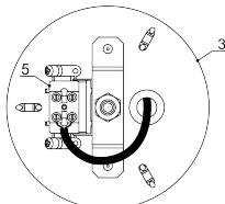
7. Пропустить тросики через центральное отверстие в потолочной чашке (2) и декоративную стойку (1). Зафиксировать чашку на основании (3). Подвесить светильник на тросиках, отрегулировав высоту подвеса (излишки тросиков откусить).
