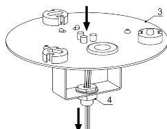
6. Установить основание чашки (3) на горизонтальную опорную поверхность с помощью саморезов (не входят в комплект поставки). Открыть крышку коннектора (5), открутить два самореза и раскрыть кабельные зажимы . Подключить сетевой провод к клемной колодке, зафиксировать его с помощью кабельного зажима и самореза.
