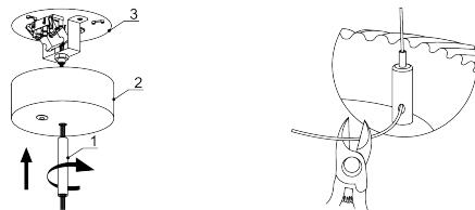
8. Відкрутити декоративну стійку (1) та опустити її разом з чашкою (2) вниз по тросиках. Пропустити провід від світильника (6) через боковий отвір у стельової чашці (2), вкоротити його на необхідну довжину, зачистити та підключити до клемної колодки. Зафіксувати провід за допомогою кабельного затискача та саморізу. Закрити кришку коннектору (5).
