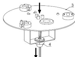
6. Өзікескіш (жиынтыққа кірмейді) арқылы айшанақ негізін (3) көлденең сүйеніш бетіне орналастырыңыз. Коннектор (5) қақпағын ашыныз, екі өзікескішті бұраңыз және кабельдік қысқышты жазыңыз. Желілік сымын клемдік қалыбына қосыңыз, кабельдік қысқыш пен өзікескіш арқылы оны қалпына салыңыз.
