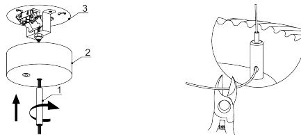
8. Открутить декоративную стойку (1) и опустить ее вместе с чашкой (2) вниз по тросикам. Пропустить провод от светильника (6) через боковое отверстие в потолочной чашке (2), укоротить его на необходимую длину, зачистить и подключить к клемной колодке. Зафиксировать провод с помощью кабельного зажима и самореза. Закрыть крышку коннектора (5).
