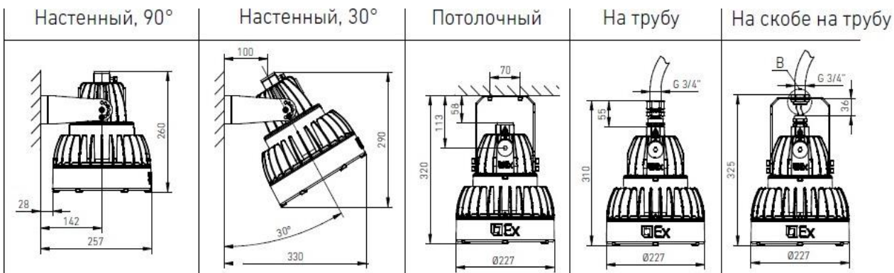
Установочные размеры (для светильников мощностью 50 - 100 Вт)
