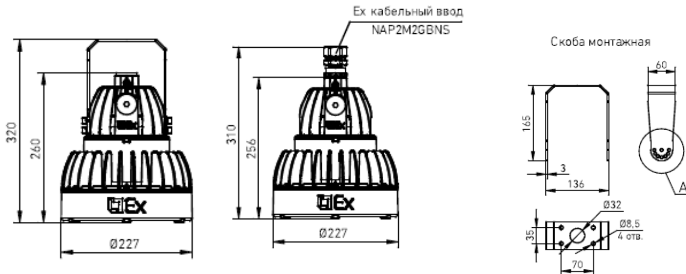
Установочные размеры (для светильников мощностью 50 - 100 Вт)
