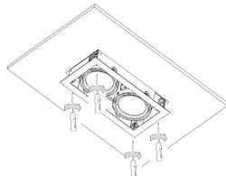
8. Отрегулировать положение и угол наклона внутренних световых частей светильника в монтажном боксе.
