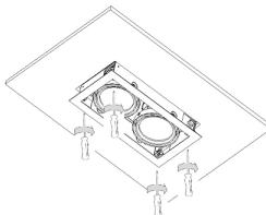
8. Відрегулювати положення і кут нахилу внутрішніх світлових частин світильника в монтажному боксі.
