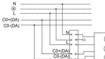
3. Схема подключения светильника к питающей сети с блоком резервного питания.
