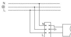
2. Схема подключения светильника к питающей сети с регулируемым драйвером по системе 1-10 V или системе DALI .
