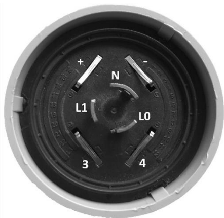
Рисунок 2 - Внешний вид контроллера, вид снизу, распиновка
