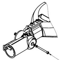
3. Установить светильник в сборе с кронштейном на консольную или торшерную опору диаметром 48-60 мм , ослабив/затянув два Винта DIN 912-M10x40 нерж. сталь A2 с помощью шестигранного ключа №8.Усилие затяжки винтов (16+2)Нм.
